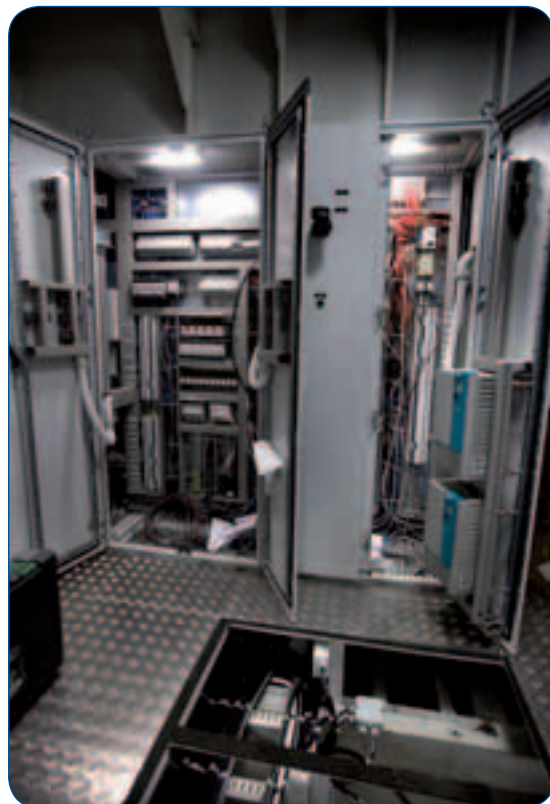
Een elektrotechnische installatie in aanbouw op de Anklajo, een schip dat Kuipers Scheepvaart binnenkort oplevert aan Vos Shipbuilding.
